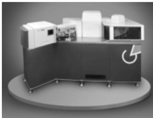
**Multicollector Isotope Ratio Mass Spectrometry (TIMS-ICP-TIMS)**. Para determinación de Isótopos con Multicollector y Fuentes de Ionización Térmica y de Plasma. Y para Isótopos de Gases Nobles (He,Ne,Ar,Kr,Xn).
