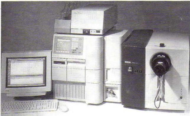
El sistema de gestión de muestras permite la inyección de hasta 120 muestras desde 5 carruseles de 24 posiciones, con la posibilidad de refrigeración o calefacción.
