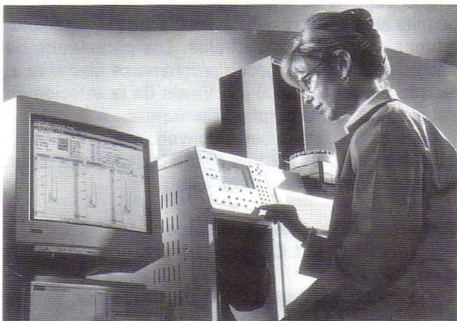
El cromatógrafo de gases Varian GC 3800, que es capaz de trabajar con tres detectores instalados conjuntamente, hace que este método sea posible. Al cromatógrafo para trabajar con este método se le ha denominado *Refinery Gas System C*.
