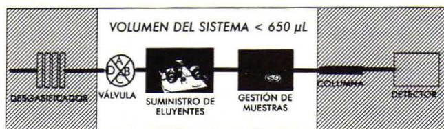
En ningún caso deben utilizarse mezcladores ni amortiguadores de pulsos.
