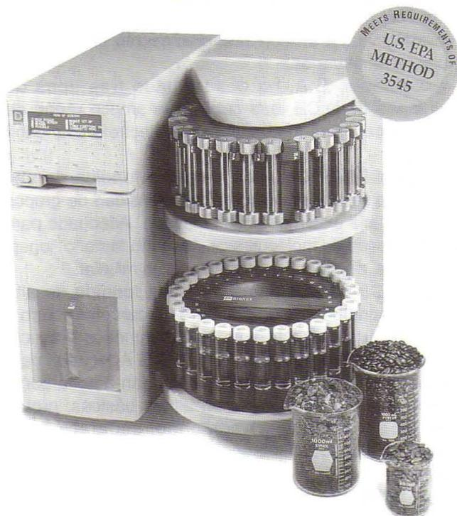
El campo de aplicación del ASE 200 es muy amplio, abarcando desde pesticidas organofosforados, herbicidas, PCBs y productos farmacéuticos, hasta alimentos y plásticos.
