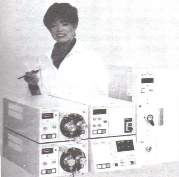
La nueva línea «Slim-2000» ofrece una completa gama de componentes para configurar el sistema HPLC exactamente a la medida de sus necesidades. Su bomba, con capacidad de producir flujos entre 10 y 9.900 microlitros/mn, hace posible el trabajo con columnas de 1 mm (microbore-1), ultrafast, analíticas y semipreparativas.
