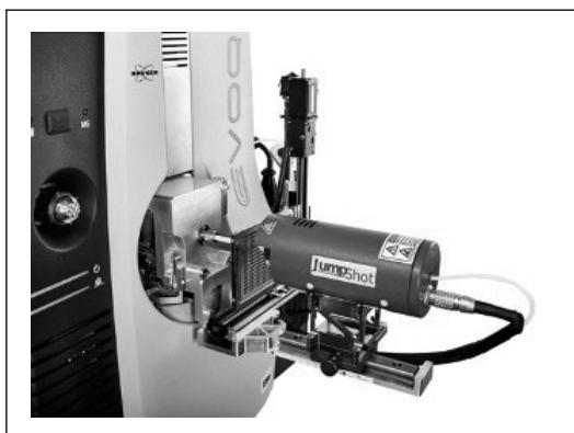
**Figura 3.** Detalle de acoplamiento sistema DART JumpShot a EVOQ MS.
